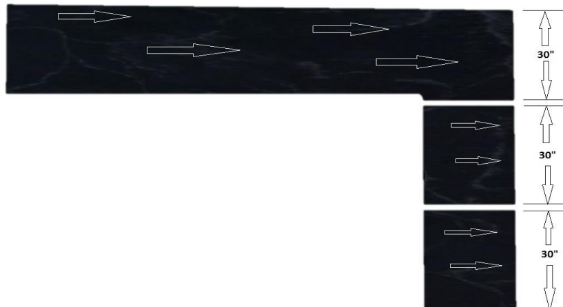
Illustration 12. Pièces de la série « Movement » de Meganite avec marbrures allant dans la même direction et décalage du coin intérieur.
