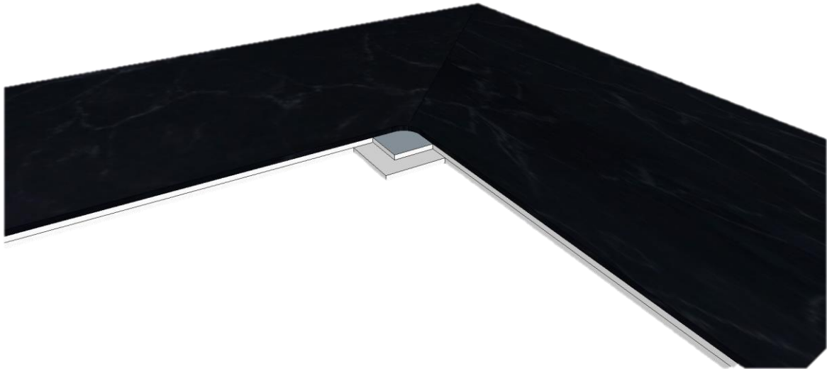
Illustration 14. Vue de dessus d'une jonction en onglets de panneaux « Movement » utilisant la méthode des « blocs de coin par emboîtement »
